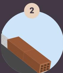
2. Poser les briques une à une avec un maillet en caoutchouc en vérifiant l'horizontalité globale à l'aide d'un niveau à bulle jusqu'à réaliser un premier rang
