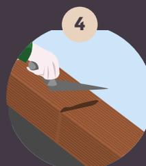
4. Pour le joint vertical, remplir la réservation prévue à cet effet qui assure une rapidité de mise en œuvre et un gain thermique. Répéter les mêmes étapes pour chaque rang jusqu'à la hauteur souhaitée
