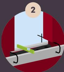
2. Fixer 2 planches de coffrage de chaque côté de l'ouverture à l'aide de serre-joints et en tenant compte de l'épaisseur de l'appui
