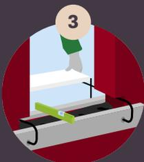
3. Remplir le coffrage de béton et mettre en place l'appui. Pour absorber toute éventuelle dilatation, placer un polystyrène
