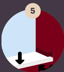
5. Pour finir, bien reboucher le joint sous l'appui et nettoyer la goutte d'eau
