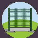
4 - Sceller le deuxième poteau en ajustant sa hauteur et sa verticalité. Soutenir l'ensemble avec des étais. Répéter les opérations sur toute la longueur et terminer avec le scellement du dernier poteau. Finir par nettoyer l'ensemble
