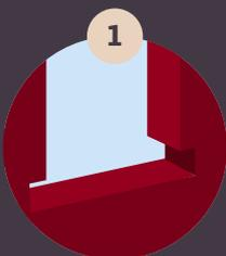
1. Laisser une réservation de 8 cm de profondeur et 15 cm de hauteur dans la maçonnerie de chaque côté des rebords de fenêtre. Positionner 2 barres d'acier de 8 mm dans le dernier joint de la maçonnerie afin d'éviter toute fissuration
