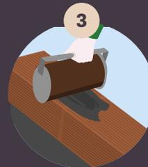
3. Réaliser le joint horizontal à l'aide d'un gabarit de pose qui ménage un joint de 1 cm d'épaisseur avec une rupture horizontale de 4 cm
